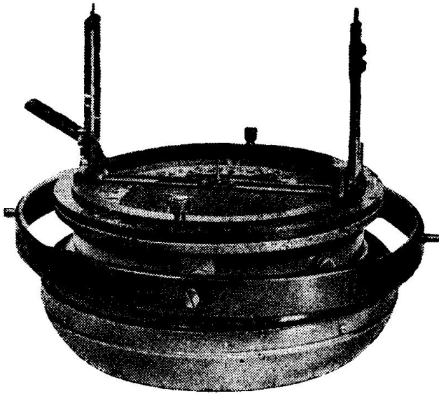
Fig. 604. Mortero con alidada (Plath)
